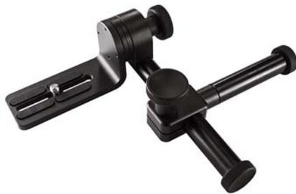
CION 用のビューファインダーマウントは、サードパーティ製の各種ビューファインダーや軽量小型のオンボードモニターに対応し、柔軟な調整が行えます。L 字型のブラケットは、回転させてビューファインダーやモニターをしっかりと固定できます。また、ロゼットとノブによって、ブラケットの角度も調整できます。15mm ロッドにより、L 字型ブラケットをさらに離れた位置や中心近くに配置することも可能です。もう一方の 15mm ロッドは、CION ハンドル部分の穴に合わせて使用します。このロッドにより、ビューファインダーマウントをカメラ本体の近くや離れた位置にスライドさせることが可能になります。これは、利き目が左目のカメラマンにとって非常に便利です。
