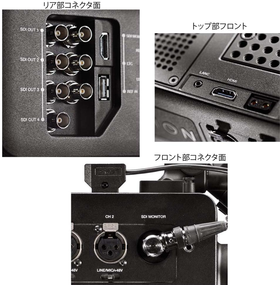
CION では、モニタリング機器のケーブル接続やバランス調整を、人間工学に基づいた設計により簡単に行えるよう、フロント部とリア部の両方に接続端子が用意されています。一般的に、電子ビューファインダーを接続する場合は、フロント部の SDI モニター端子を使用するのが便利です。SDI 入力で接続ができない電子ビューファインダーを使用する場合は、フロント部に取り付けられている HDMI 接続を利用できます。
