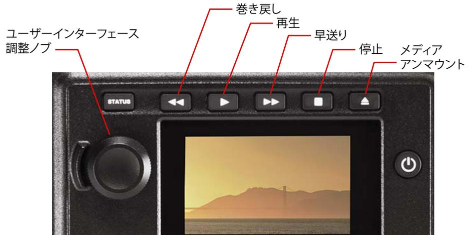
**停止ボタン:** 停止ボタンには2つの機能があります。クリップの再生（再生、早送り、巻き戻し）中に停止ボタンを1回押すと「一時停止」モードになって再生が一時停止し、その時点のクリップが表示された状態で停止ボタンが点滅します。停止ボタンをもう1回押すと再生が完全に停止し、CIONの出力はライブビューを表示する「E-to-E」モードに戻ります。
