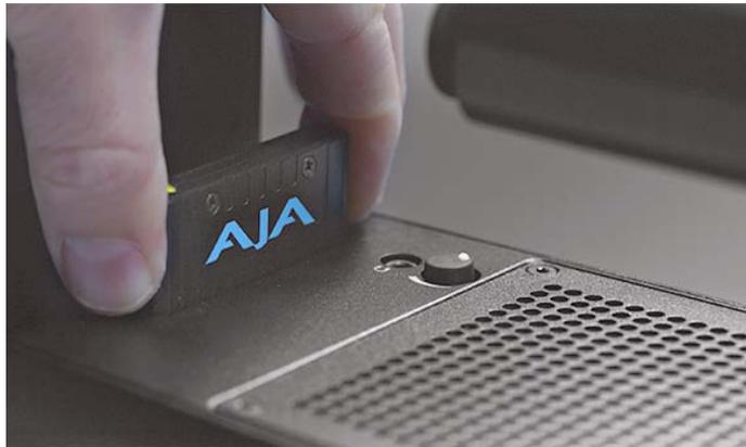
3. Pak Media を挿入するとスキャンが行われ、ユーザーインターフェースディスプレイに「Media Mounting (メディアのマウント中)」と表示されます。
