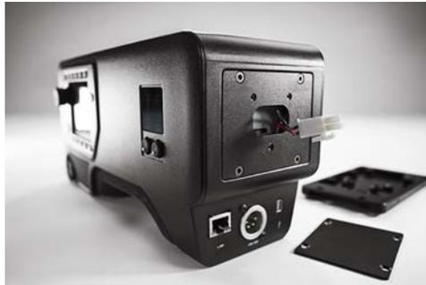
3. 4-40 押さえねじ 3 本を使用し、バッテリーアダプタープレートを取り付けます。
