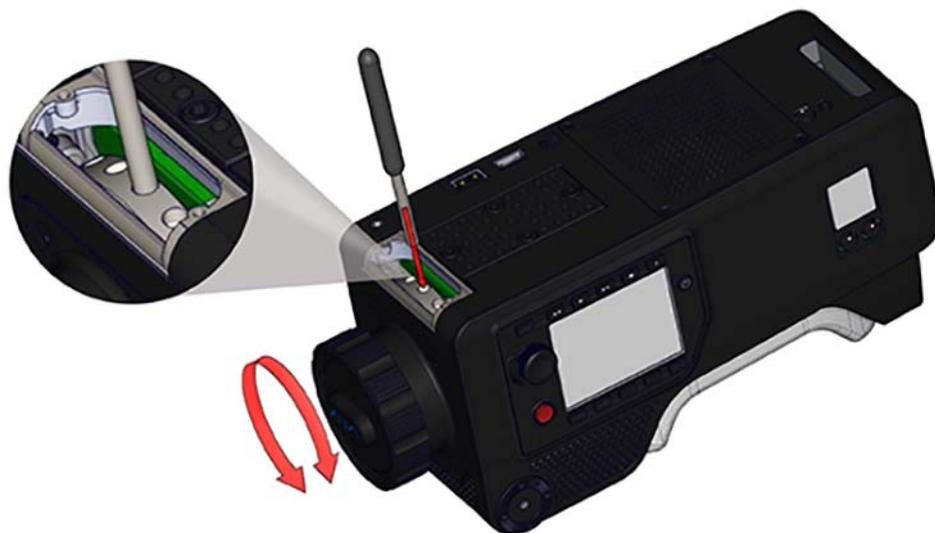
バックフォーカスツールは、CION のフランジ焦点距離を精密に調整するために使用します。CION のフロント部分には、バックフォーカスアクセスドアがあります。このドアにアクセスするには、CION に付属するトップハンドルを取り外す必要があります。
