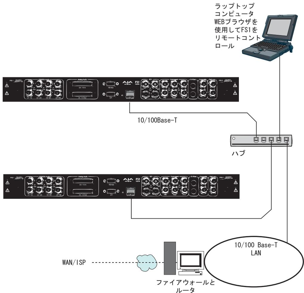
**FS1 のネットワーク例：LAN 接続した 2 台の FS1 をラップトップコンピュータでリモートコントロール**
